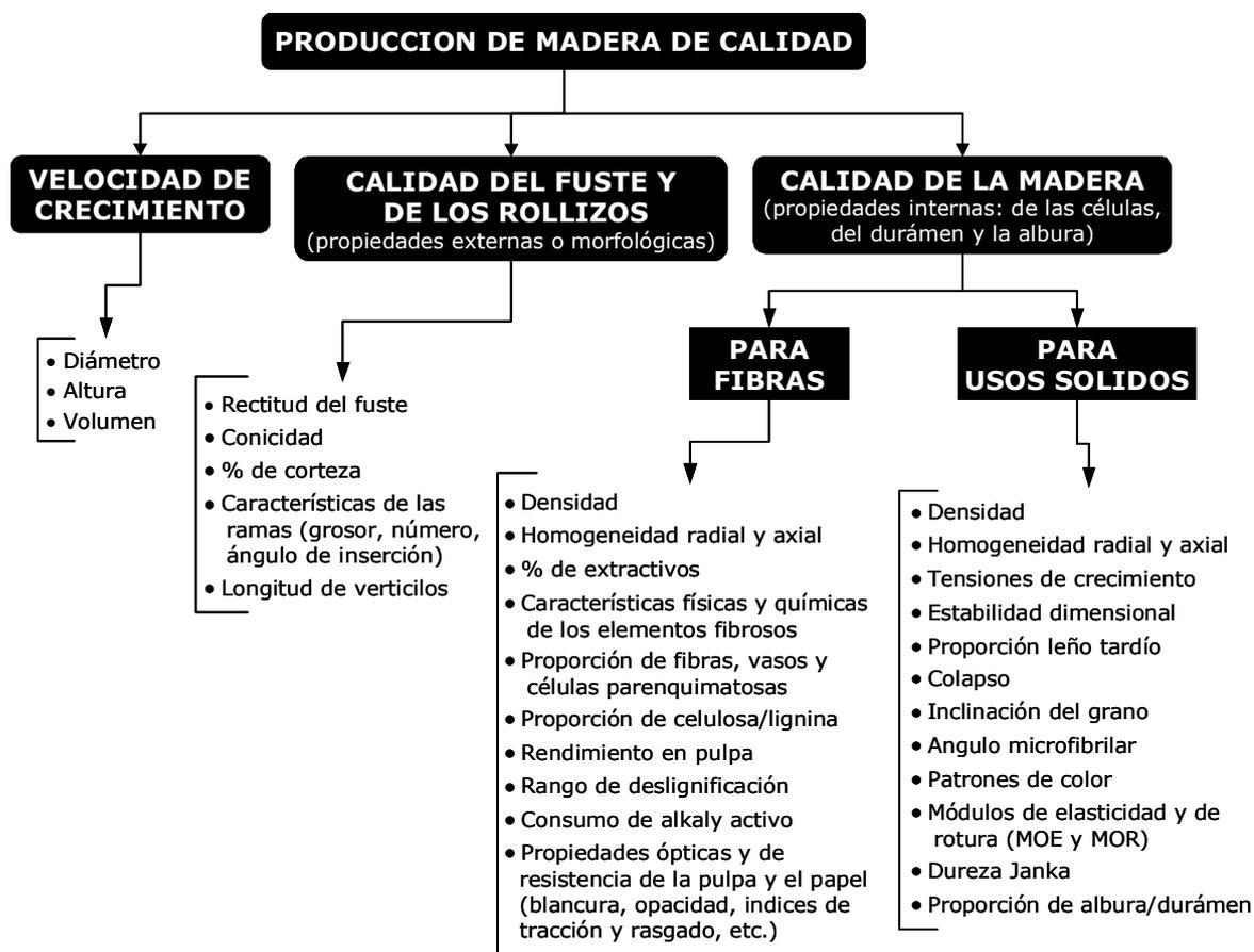
**FIGURA I.** Componentes de la producción de madera de calidad para fibras y para usos sólidos
