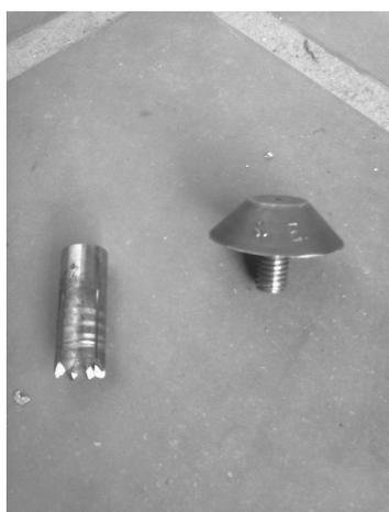
Figura 2. Marca y Broca para Punto de la Red Geodésica.
