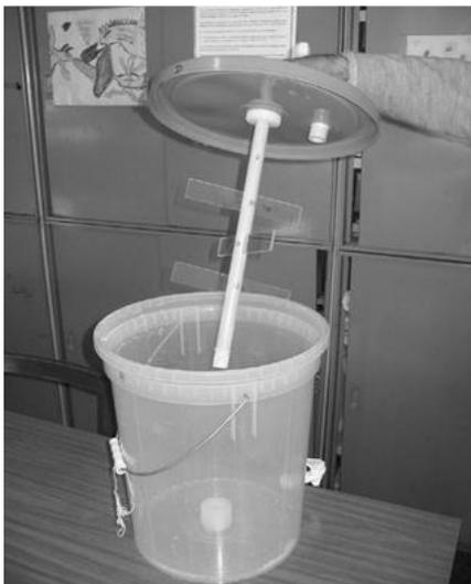
Figura 2. Balde mezclado de alufloc y ferrifloc.
