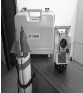
Fotografía 1. Imagen de Estación Total TRIMBLE, de última generación.
