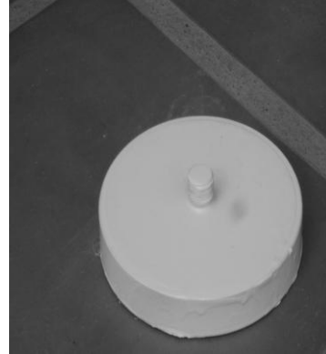
Fotografía 3. Base para el centrado forzoso.
