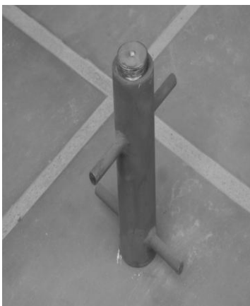
Fotografía 2. Tornillo de fijado forzoso
