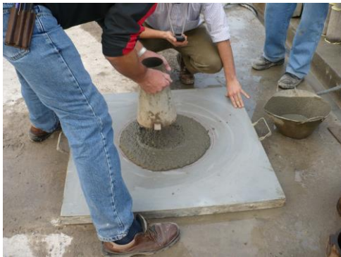
Foto 2. Ensayo de extendido y T_{50}
