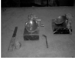
Figura 3. Aparatos para la determinación del límite líquido 1. Laboratorio de Materiales Viales
