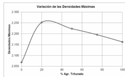
Gráf. 8. Variación de la densidad máxima en función de la cantidad de agregado triturado reemplazado
