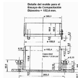
Figura 5. Ensayo de compactación. Molde reglamentario
