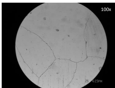
Figura 3. Granos de Ferrita \alpha en aceros inoxidables tipo AISI 446.
