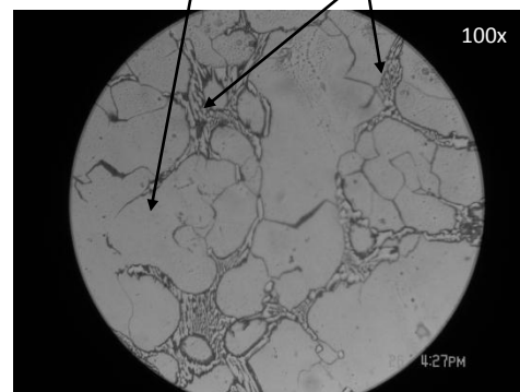
Figura 2. Los bordes de grano de la austenita muestran presencia de microfases de tipo Perlita. A pesar de haber aplicado hipertemple, se observan precipitados en borde grano (Perlita). No hay presencia de microfases dentro de los granos de austenita.
