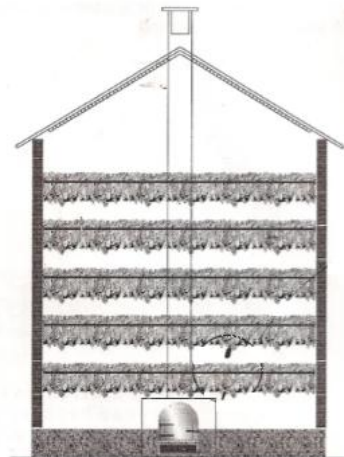
Figura 1. Esquema simplificado de una estufa para secado de tabaco.
