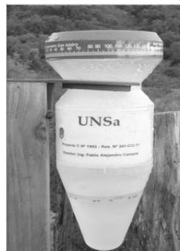
Figura 7. Pluviómetro
