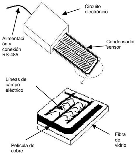
Figura 1: Cuerpo del Sensor Capacitivo de Humedad de Hoja.
