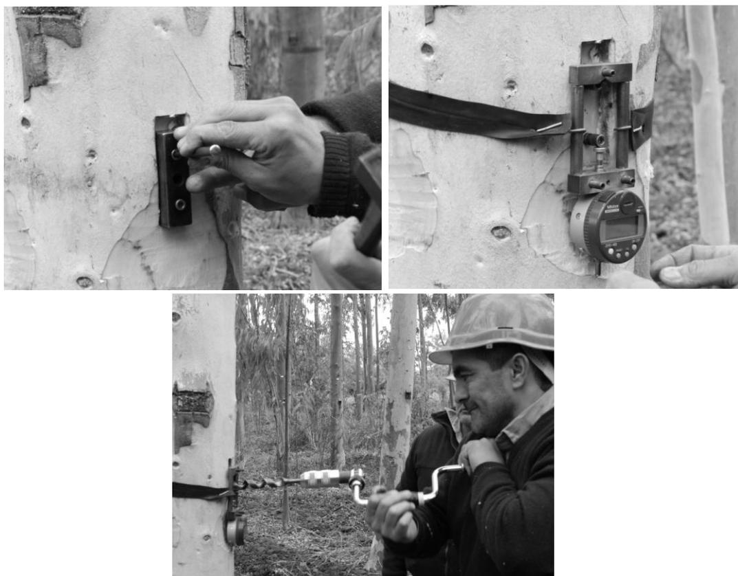
Figura 1. Medición de tensiones de crecimiento con extensómetro CIRAD-Forêt
