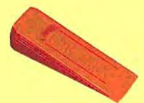
Foto A40: Cuña de plástico. Ventaja: menor peso, no daña la cadena de la motosierra en caso de toque
