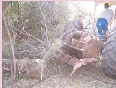
Foto G24: Falta de medidas de seguridad en el tractor
