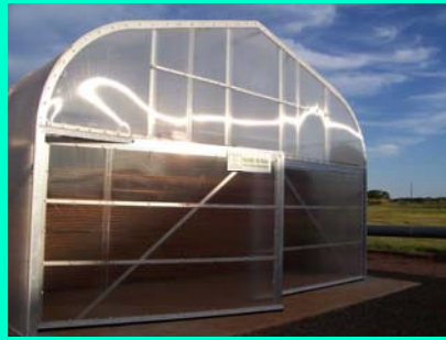
Foto N15: Secadero de madera
