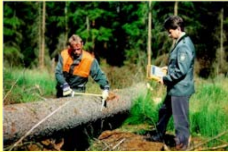
Foto A12: Medición del diámetro con forcípula
