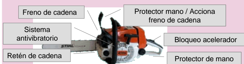
Foto G22: Elementos de seguridad en una motosierra
