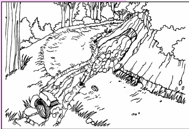
Foto C26: Problemas de drenaje por falta de mantenimiento
