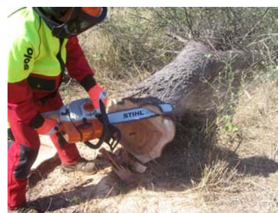
Foto A57: Corte de aletas facilita el arrastre
