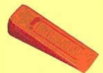
Foto A52: Cuña de plástico. Ventaja: menor peso, no daña la cadena de la motosierra en caso de toque
