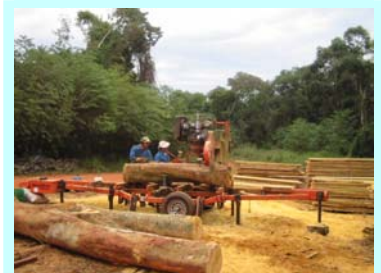
Foto S25: Aserrado de fustes de árboles maduros con sierra móvil
