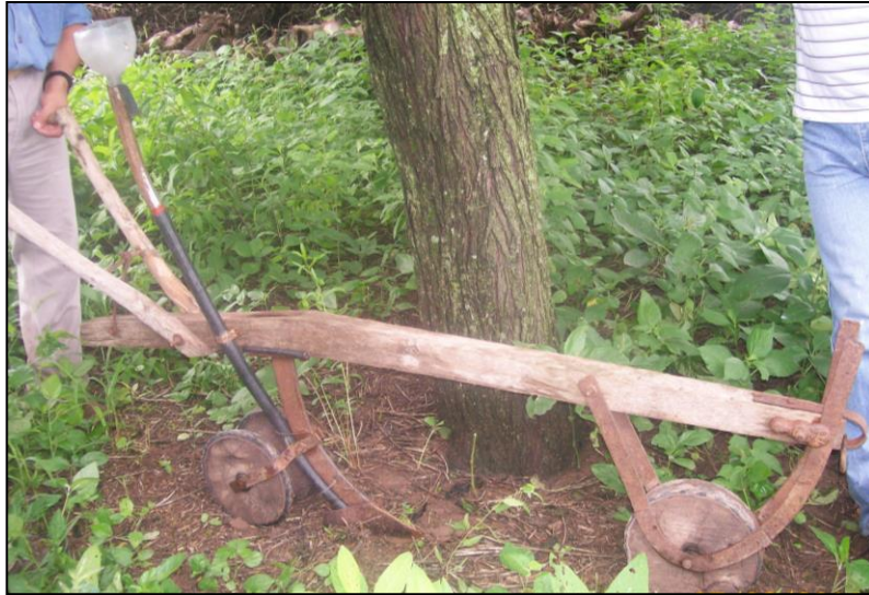
Figura 33– Adaptación de implemento de siembra en arado mansera
