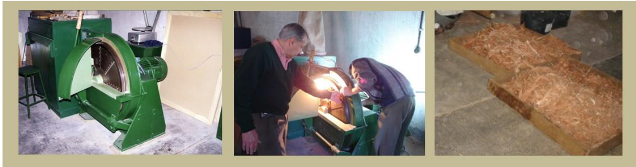
Figura N° 9: Imágenes del equipo chipeador BENZER, de la calibración del mismo y de los chips obtenidos. Fuente: Dr. Ing. J. C. Medina.
