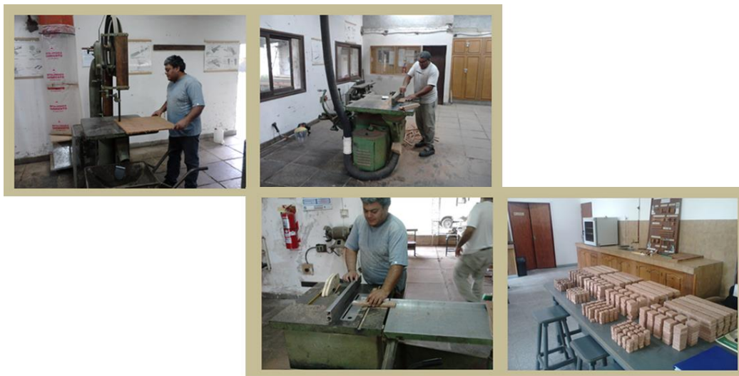
Figura N° 20: Obtención de las probetas en la carpintería para los ensayos de humedad, peso específico, hinchazón y flexión estática. Fuente: Elaboración propia.
