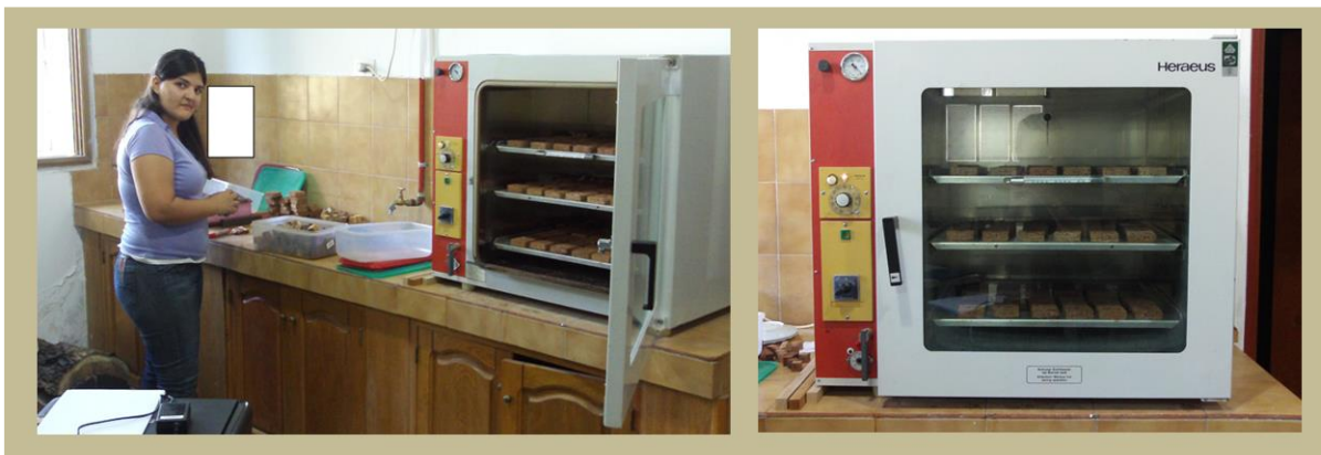
Figura N° 21: Imágenes de las probetas en la estufa para la determinación de la humedad. Fuente: Elaboración propia.
