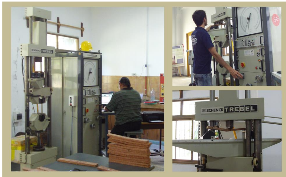
Figura N° 25: Imágenes de los ensayos a la flexión para la determinación del MOR y MOE. Fuente: Elaboración propia.
