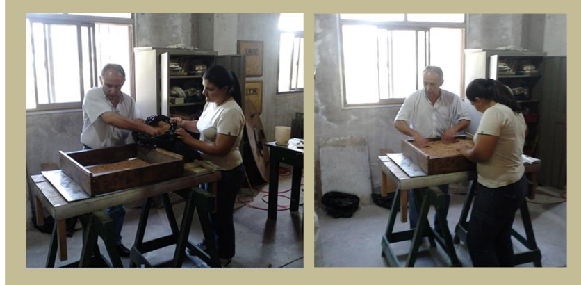
Figura N° 14: Imágenes de la formación del colchón de virutas. Fuente: Elaboración propia.
