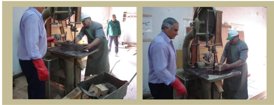
Figura N° 7: Reaserrado de la madera de Eucalipto para obtener muestras compatibles con la boca de alimentación de la chipadora. Fuente: Dr. Ing. J. C. Medina.
