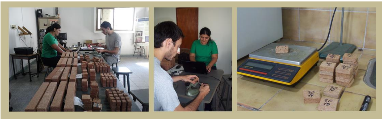
Figura N° 22: Imágenes de la determinación del peso específico. Fuente: Elaboración propia.
