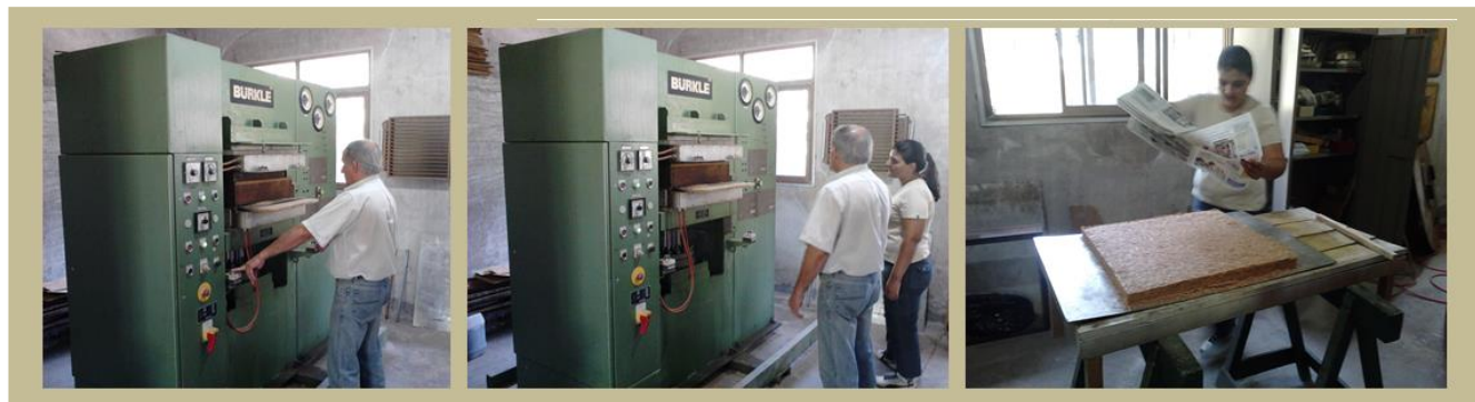
Figura N° 16: Imágenes del pre-prensado y del colchón de virutas compactado. Fuente: Elaboración propia.
