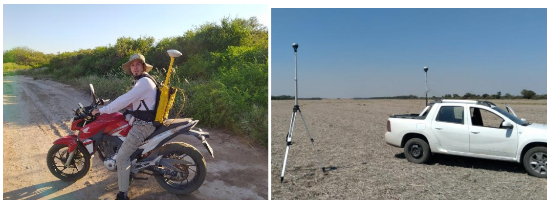
Figura 22. Equipo de Relevamiento Cinemático con RTK. Fotografías tomadas por el autor (2022 y 2025).
