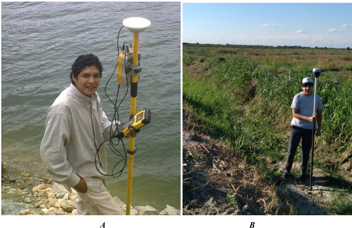
Figura 21. Posicionamiento cinemático, Stop and Go, A. para el relevamiento de líneas de costa. B. para la determinación de pendientes en acequias. Fotografía tomada por el autor (2001 y 2026 respectivamente).
