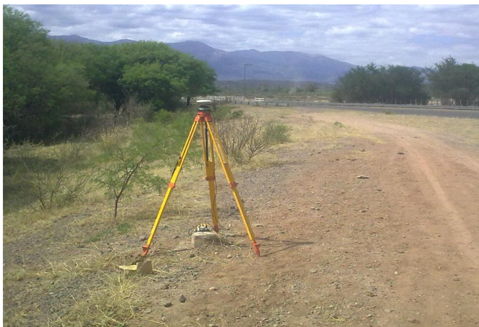
Figura 19. GPS en Posicionamiento estático sobre mojón. Fotografía tomada por el autor (2010)
