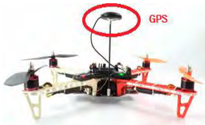
Posicion del sensor GPS en un cuadricoptero.
