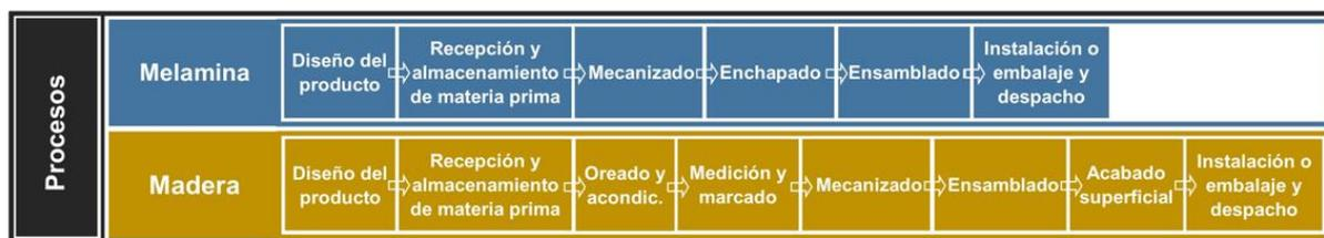
**Figura VIII.16.** Diagrama de flujo general de procesos de carpintería con placa y con madera. Fuente: Corbalán *et al.* (2023).
