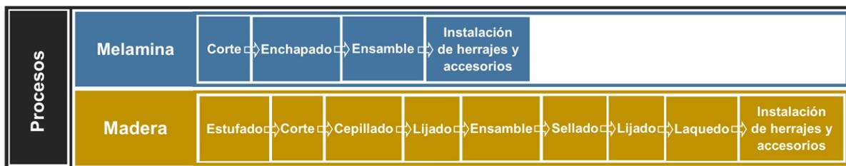
**Figura VIII.15.** Diagrama de flujo de procesos de carpintería con placa y con madera. Fuente: TABLERED Arauco (2025).
