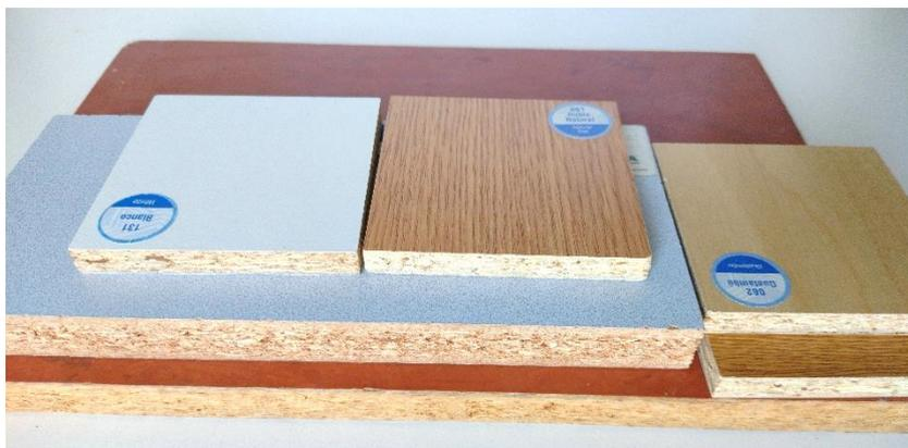
**Figura V.3.** Tableros de partículas recubiertos.
