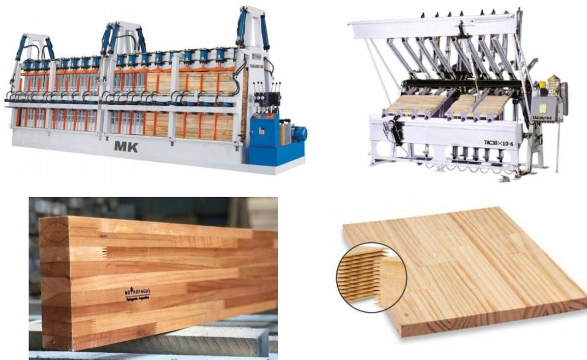
**Figura VIII.8.** Prensa de vigas laminadas y prensa de tableros alistonados. Fuente: Taurus (2025), Maderera Topic (2025) y Maderas Moral (2025).
