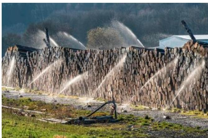
**Figura II.3.** Cancha de trozas de almacenamiento en húmedo. Sistema de aspersión.
