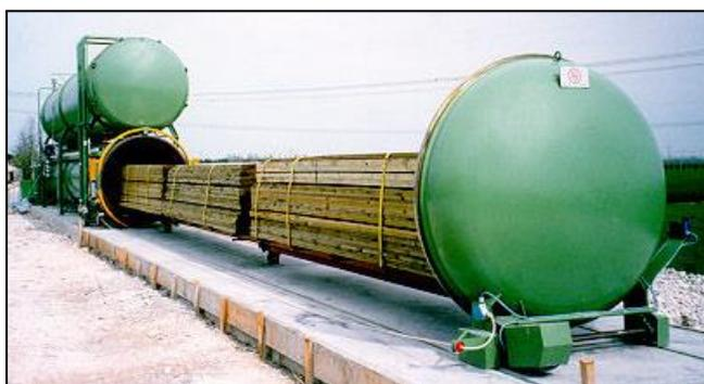
**Figura IV.4.** Autoclave para la preservación de la madera
