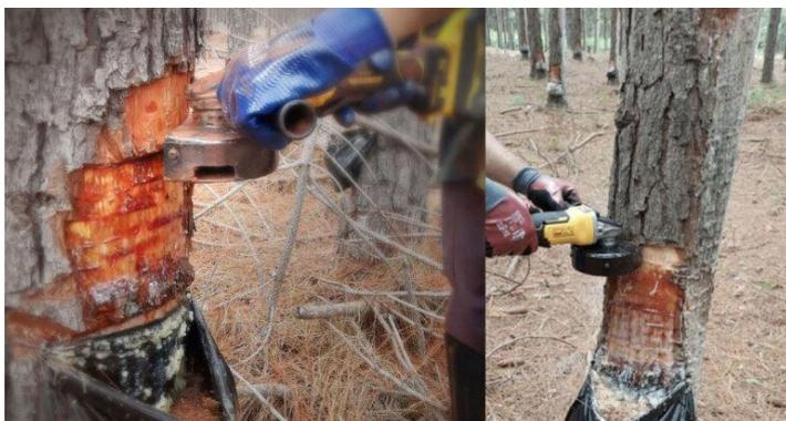
**Figura IX.4.** Máquina desarrollada en Brasil para extracción de resina. Fuente <https://www.argentinaforestal.com/wp-content/uploads/2023/05/Brasil-Irani-Mecanizacion-1-768x411.jpg>
