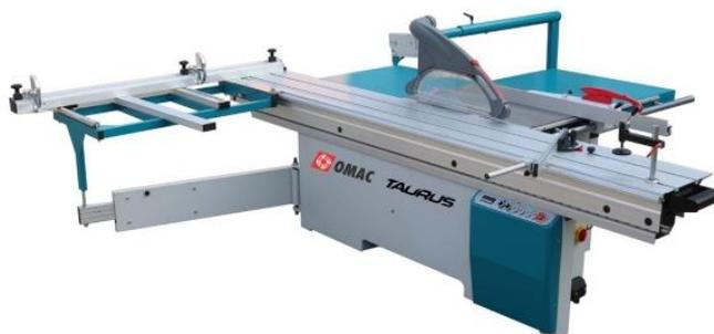
**Figura VIII.9.** Sierra seccionadora horizontal. Fuente: Taurus (2025).
