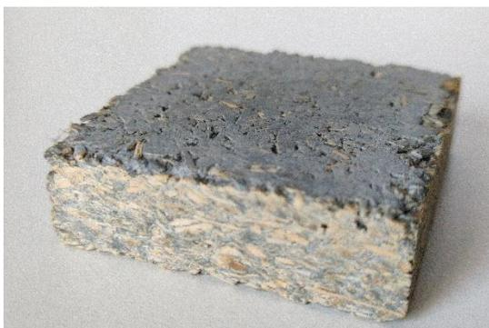
**Figura V.7.** Tablero de madera-cemento.
