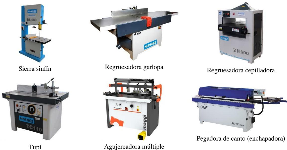
Figura VIII.17. Máquinas para carpintería. Caseros M. (2025).
