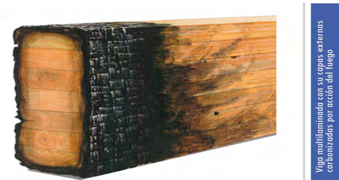
**Figura 39.** Viga multilaminada con capas externas carbonizadas. Fuente: García (2021).
