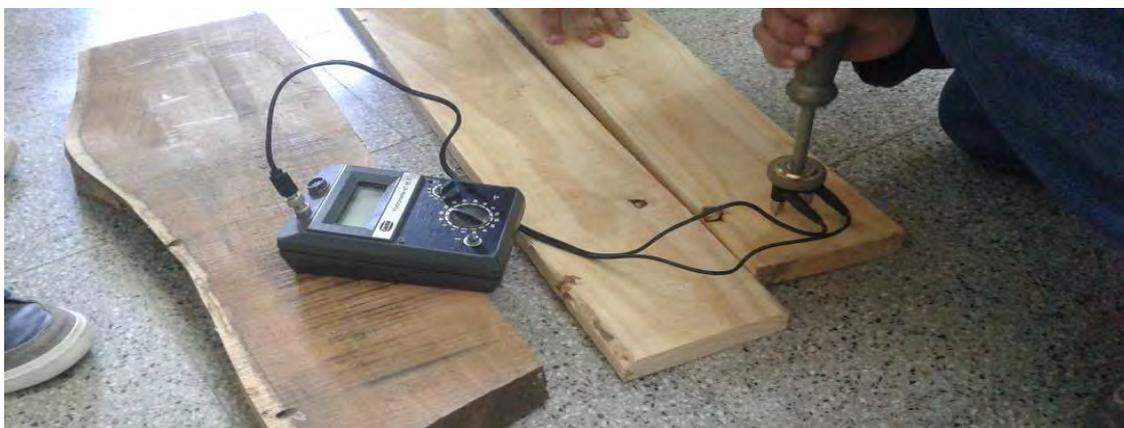
**Figura 18.** Medición del contenido de humedad con xilohigrómetro de resistencia. Imágenes: Los autores
