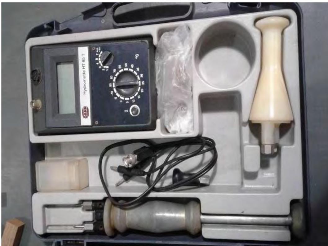
**Figura 20.** Xilohigrómetro de resistencia. Imágenes: Los autores
