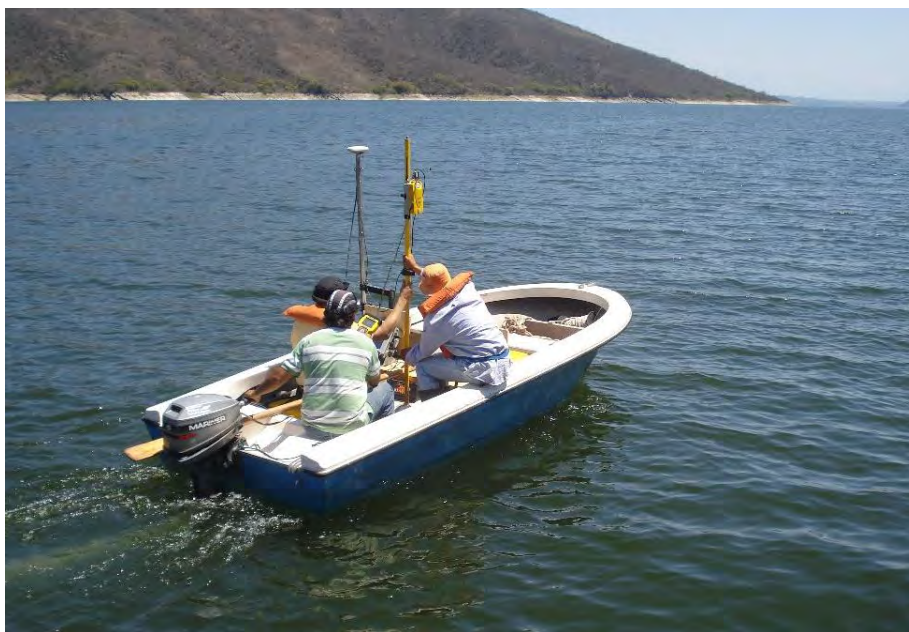
Figura 20. Posicionamiento cinemático continuo. Navegación de transectas para realizar cálculos batimétricos. Fotografía tomada por el autor (2020).
