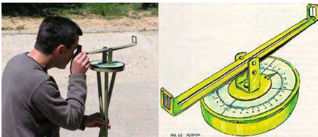
Figura 2. Determinación de un Angulo con alidada. Sanjuán Fernández, (2016).
