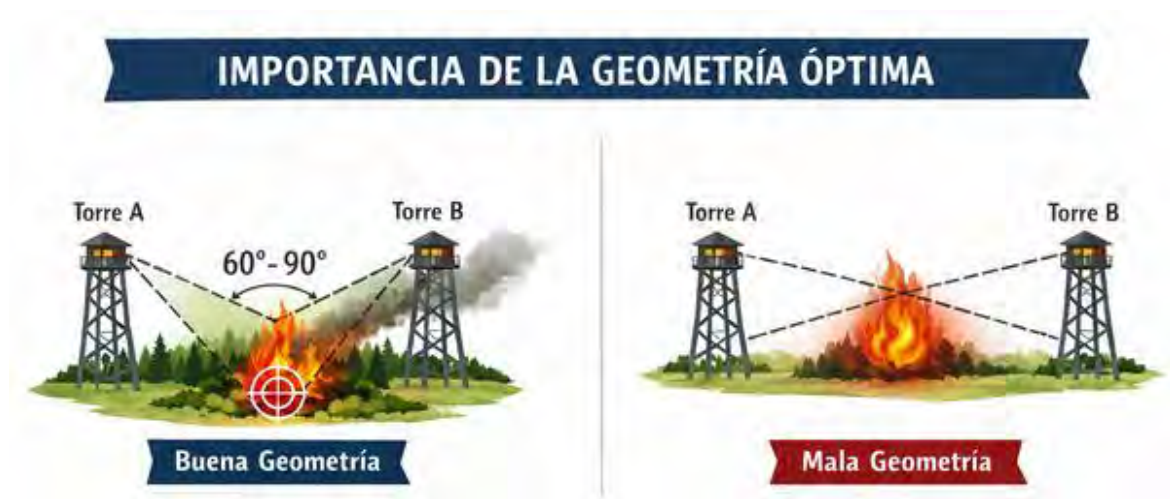
Figura 4. Error en la detección por triangulación. El error aumenta si las torres están alineadas con respecto al foco de incendio. Elaboración propia
