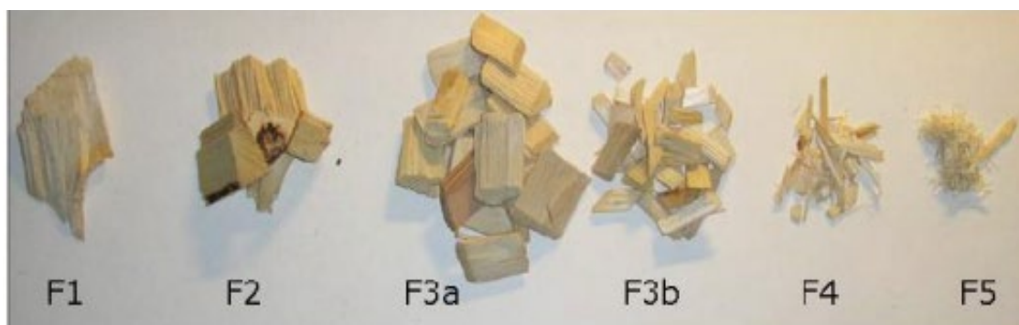
Figura 3.3. Astillas obtenidas del clasificador. F1 sobre tamaño, F2 sobre espesor, F3a aceptado, F3b aceptado, F4 pin chip, F5 finos. Fuente: Robles Santos (2011).
