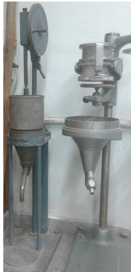
Figura 1. Aparatos de laboratorio para medir drenabilidad de pulpa celulósica (izq.: Schopper Riegler, der: Canadian Freeness)
