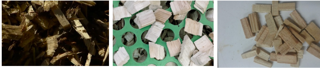
Figura 3.4. Tamaño de chips y homogeneidad de chips obtenidos de astilladora de cuchillas para industrias y en carpintería para laboratorio.
