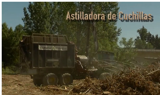
Figura 3.1. Astilladora de cuchillas a campo y en fábrica, con alimentación horizontal.
