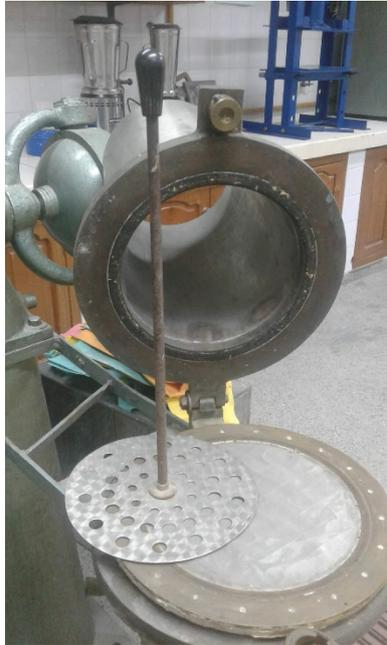
Figura 2. Agitador del formador de hoja.
