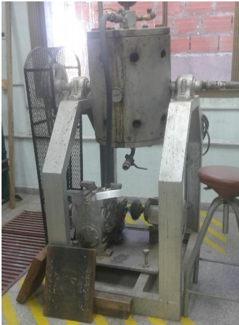
Figura 7.1. Digestor discontinuo, rotativo de laboratorio.
