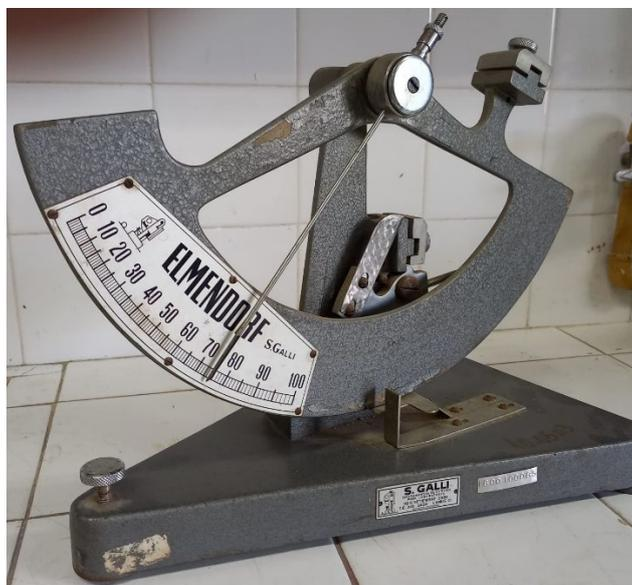
Figura 4. Aparato para ensayo de resistencia al rasgado.
