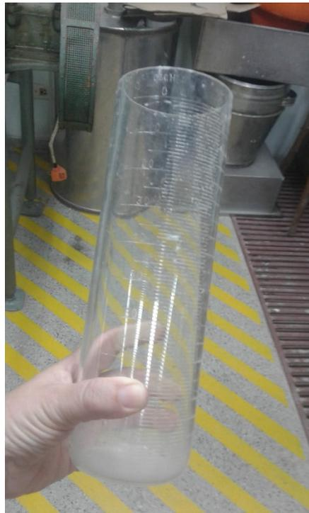
Figura 3. Probeta de medición.
