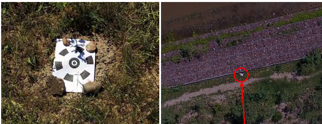
Derecha: Diana sobre base. Izquierda: Foto en la zona de base, se observa la diana utilizada.
