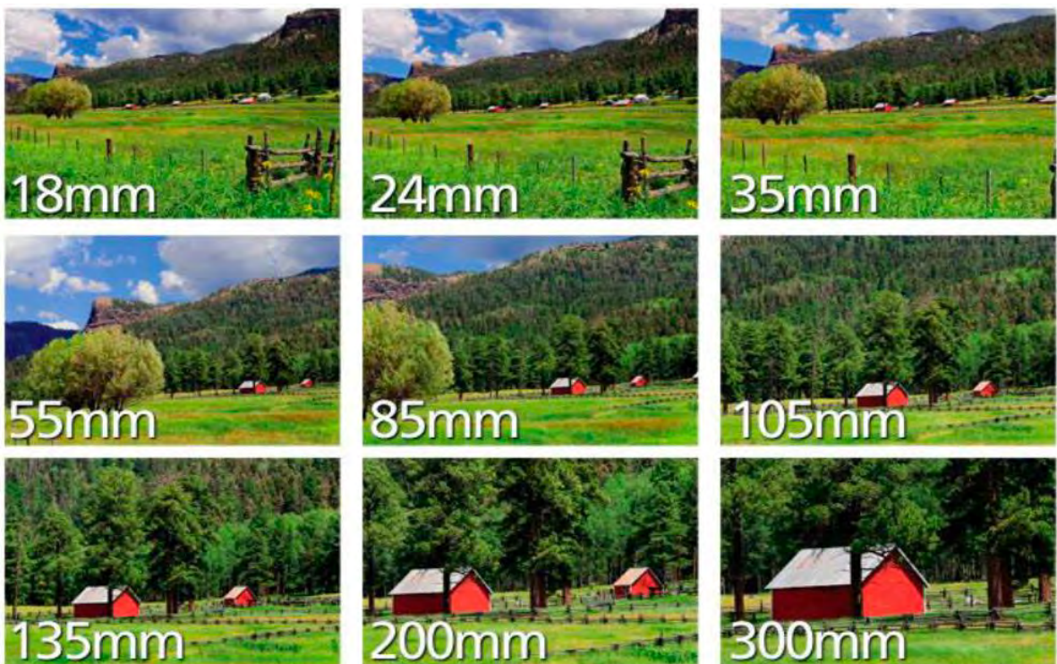
Diferencia de FOV en una fotografía, con respecto a la distancia focal de la lente.
