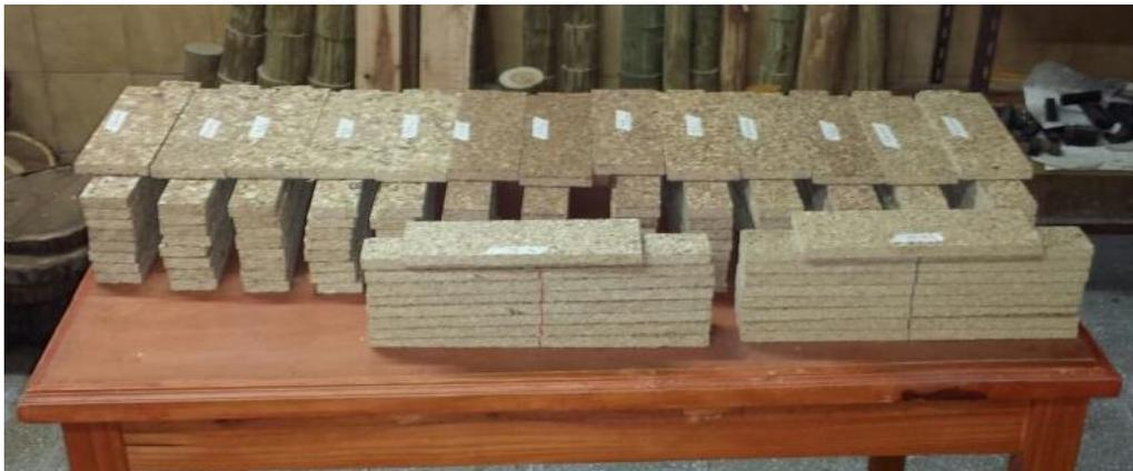
**Figura 10.** Estabilización de las probetas para ensayos físicos y mecánicos.
