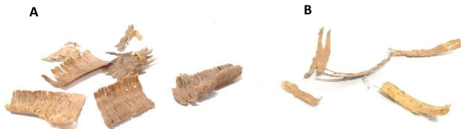
**Figura 13.** A) Aspecto de las virutas de algarrobo resultantes de la operación de cepillado B) aspecto de las virutas de algarrobo tratadas en molino.
