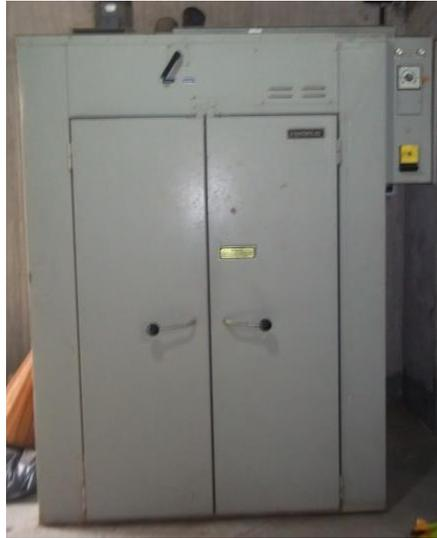
**Figura 4.** Estufa utilizada para el secado de las partículas.
