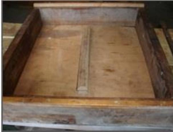
**Figura 7.** Molde para formación del colchón de partículas.
