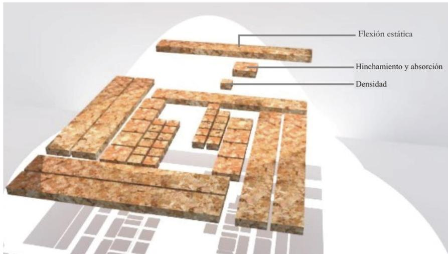
**Figura 9.** Corte de probetas en tablero para ensayos físicos y mecánicos.
