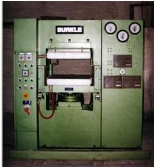
**Figura 8.** Prensa hidráulica de platos calientes.
