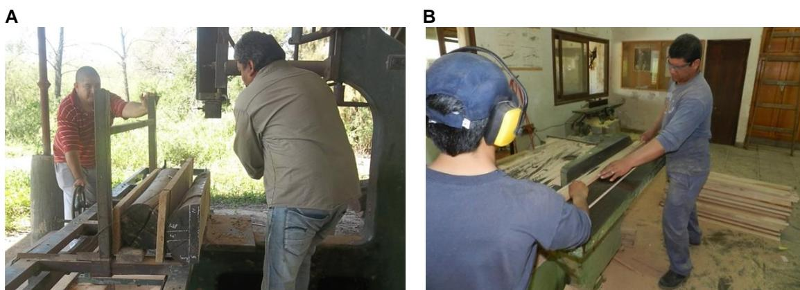
**Figura 14. A** - Transformación de trozas en tablones centrales de dirección Norte-Sur. **B** - Elaboración de listones para obtención de probetas en diferentes posiciones radiales.
