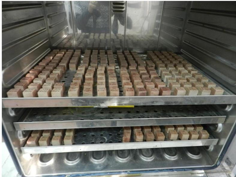
**Figura 16.** Obtención de peso seco mediante secado de muestras en estufa
