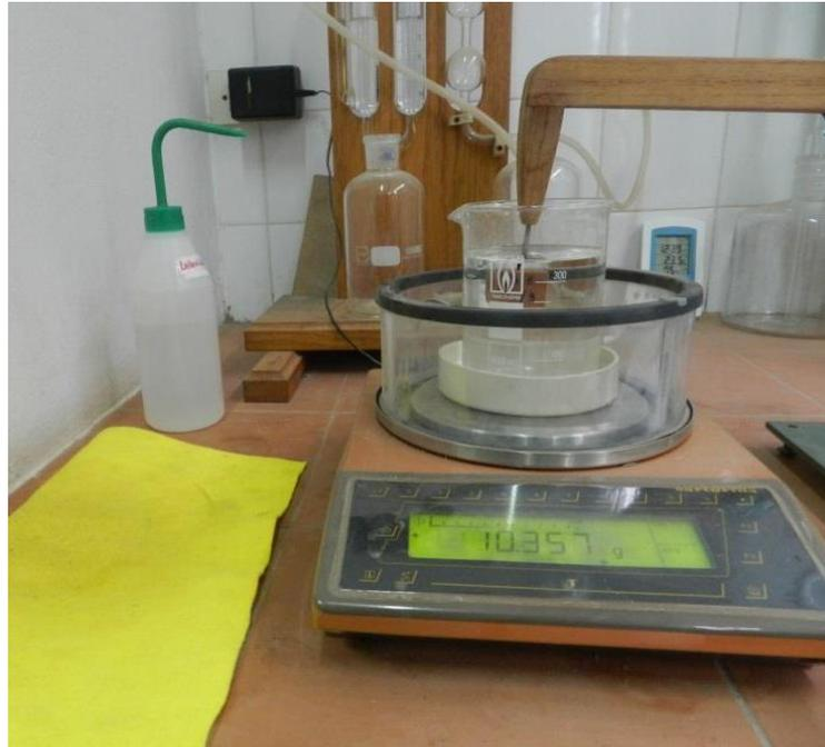
**Figura 18.** Determinación de volumen verde de las muestras
