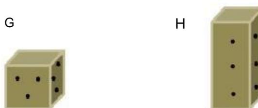
**Figura 21.** Toma de espectro en las probetas. **G** - Densidad; **H** – Contracción e Hinchamiento
