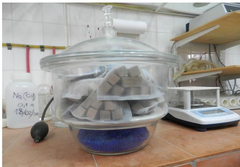
**Figura 17.** Peso de muestras con utilización de desecador para evitar absorción de humedad
