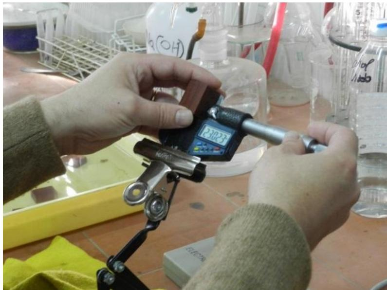
**Figura 19.** - Medición de longitudes en dirección tangencial, radial y longitudinal en estado saturado
