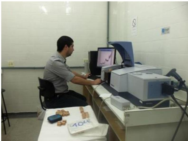
**Figura 20.** - Colecta de espectros con espectrofotómetro Bruker – Tensor 37
