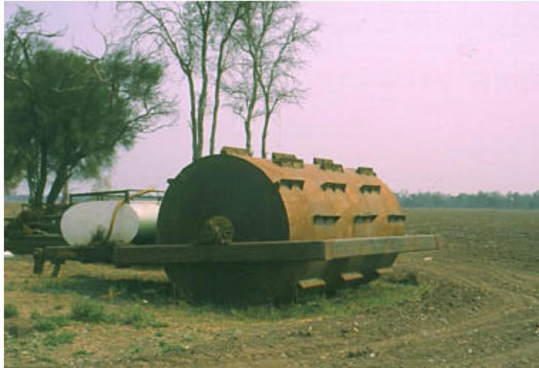
**Foto N° 2.** Rolo trozador de grandes dimensiones y muy pesado utilizado para aplastar los componentes más bajo de la cobertura forestal y facilitar el trabajo de la topadora.
