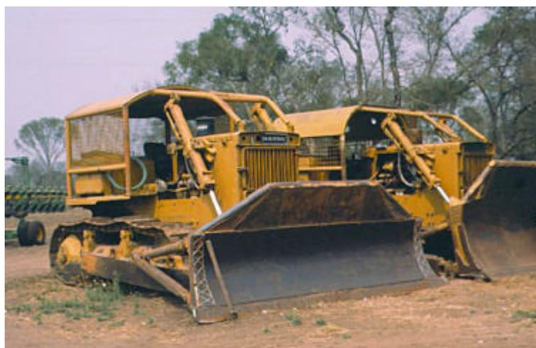
**Foto N° 1.** Topadora utilizada para el desmonte.
