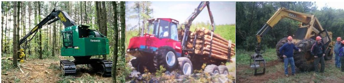
Figura 2. Harvester, forwarder y tractor trineumático.
