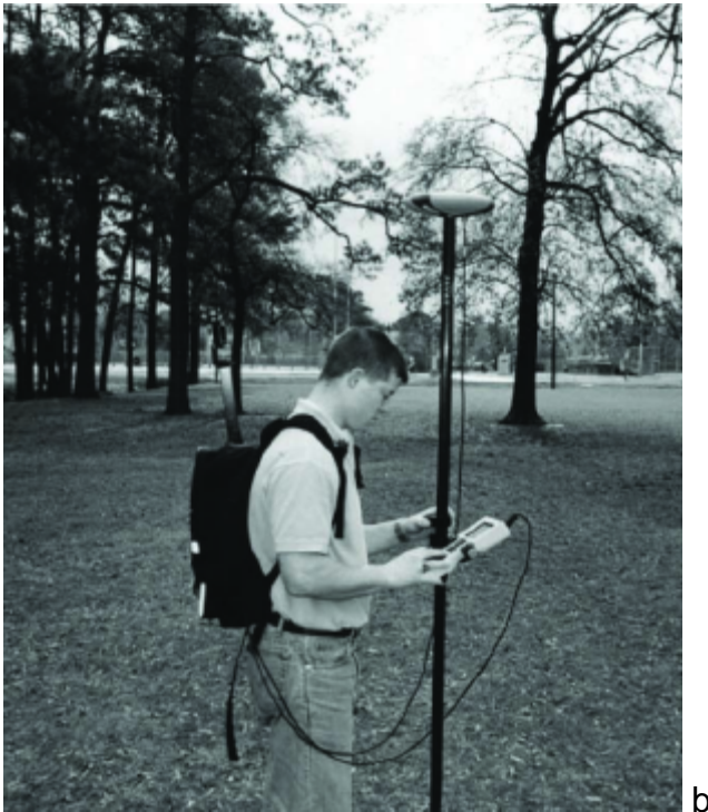
Figura 29: Fotografías de un sistema DGPS, a Estación Base, b Receptor móvil (también llamado Rover).
