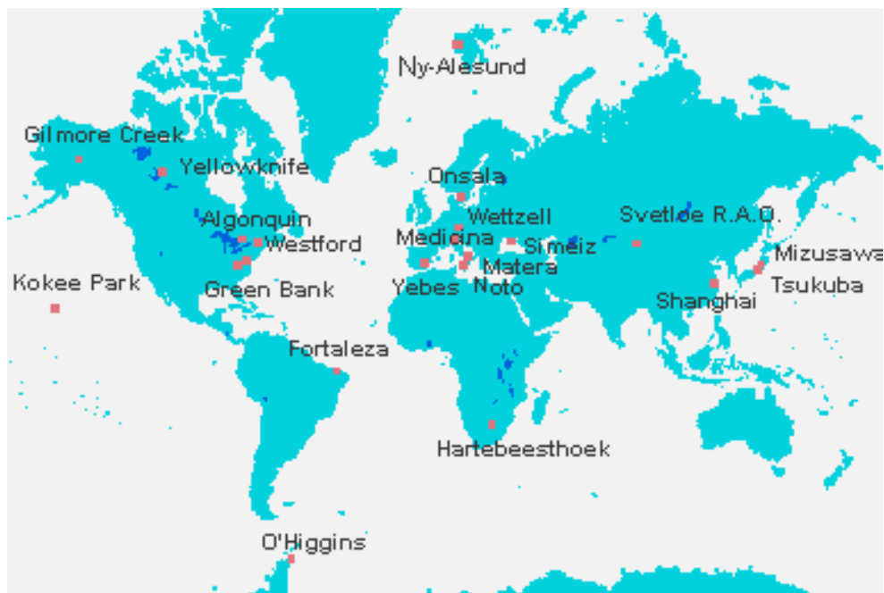
Figura 10: Los puntos rojos en el planisferio, muestran la posición de algunas Antenas VLBI, que toman parte en mediciones geodésicas VLBI.
