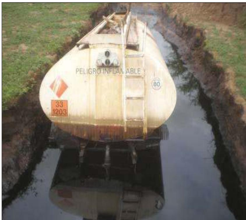
**Figura N° 9:** se observa un camión cisterna dentro de un “pozo” donde se lo ubico para que derrame su contenido ante una ruptura de su pared. La contaminación tanto de suelo como de napa que se generó fue significativa. Imagen de los Autores año 2.012.
