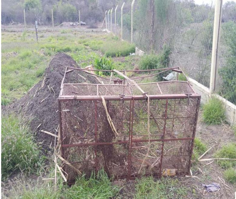
**Figura N° 5:** Canasto metálico con el que se “desenlama” el vaso de la presa. El producto del desenlamado, que es el montículo que se observa atrás del canasto, se vuelca en sitios elegidos al azar y se lo deja esparcido como el que se ve en la fotografía, generando Pasivos Ambientales. Fotografía propia.
