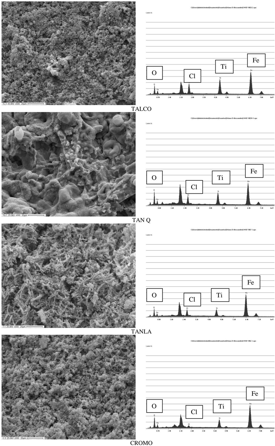
**Figura 5.** Microfotografías a 500x de las electrodos de trabajo.
