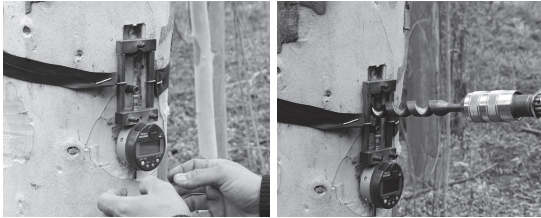
Figura 1. Medición de tensiones de crecimiento con extensómetro CIRAD-Forêt
