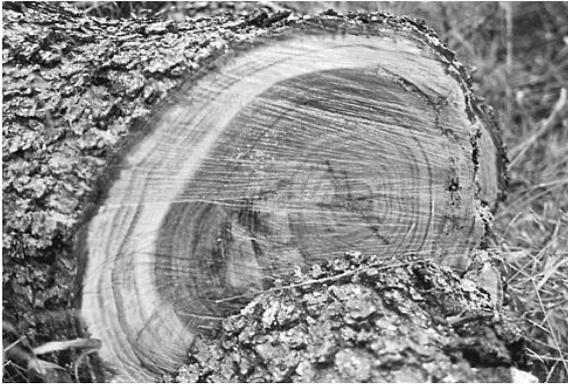
**Figura 6.** Sección transversal de un fuste de *Schinopsis quebracho-colorado*, donde se manifiesta la diferencia de color entre albura y duramen.
