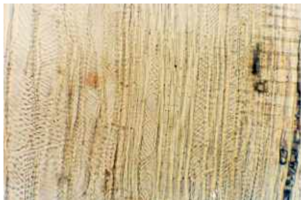
Figura 6. Sección radial de leño. Presencia de fibrotraqueidas (x 200).
