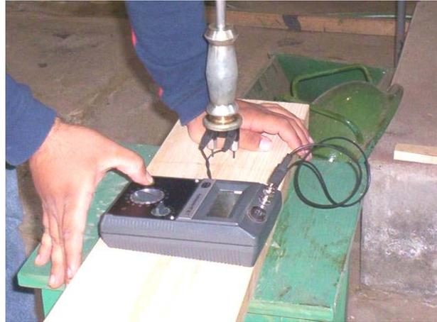
**Fig. 1.** Control del contenido de humedad
