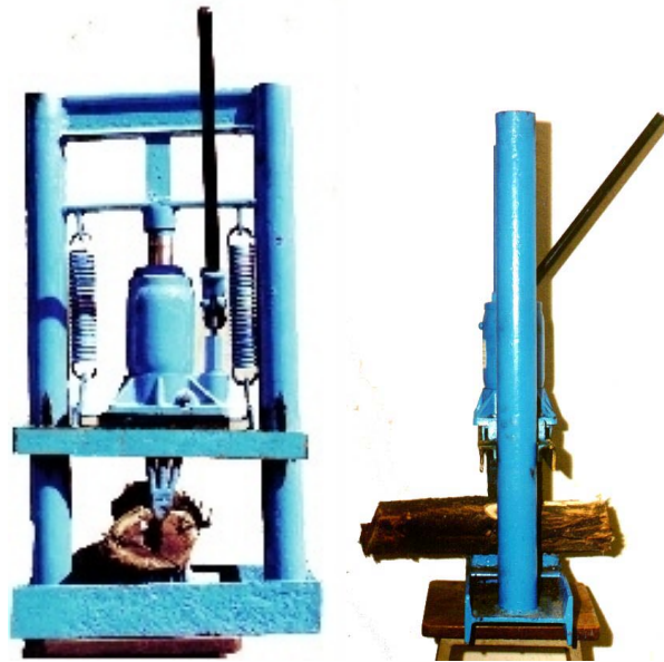
Figura 2: Prensa hidráulica adaptada para el seccionamiento longitudinal de palos, para obtención de estados inmaduros y adultos de Torneutes pallidipennis . Izquierda vista frontal. Derecha vista lateral
