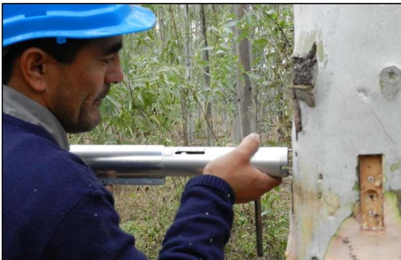
**Figura 3.** Disparo y lectura de penetración con pilodyn.
