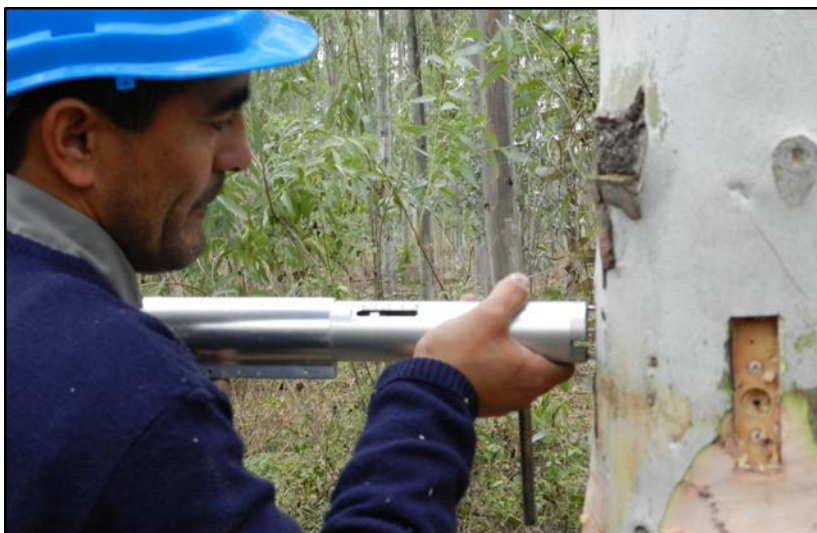
Figura 3. Disparo y lectura de penetración con pilodyn.
