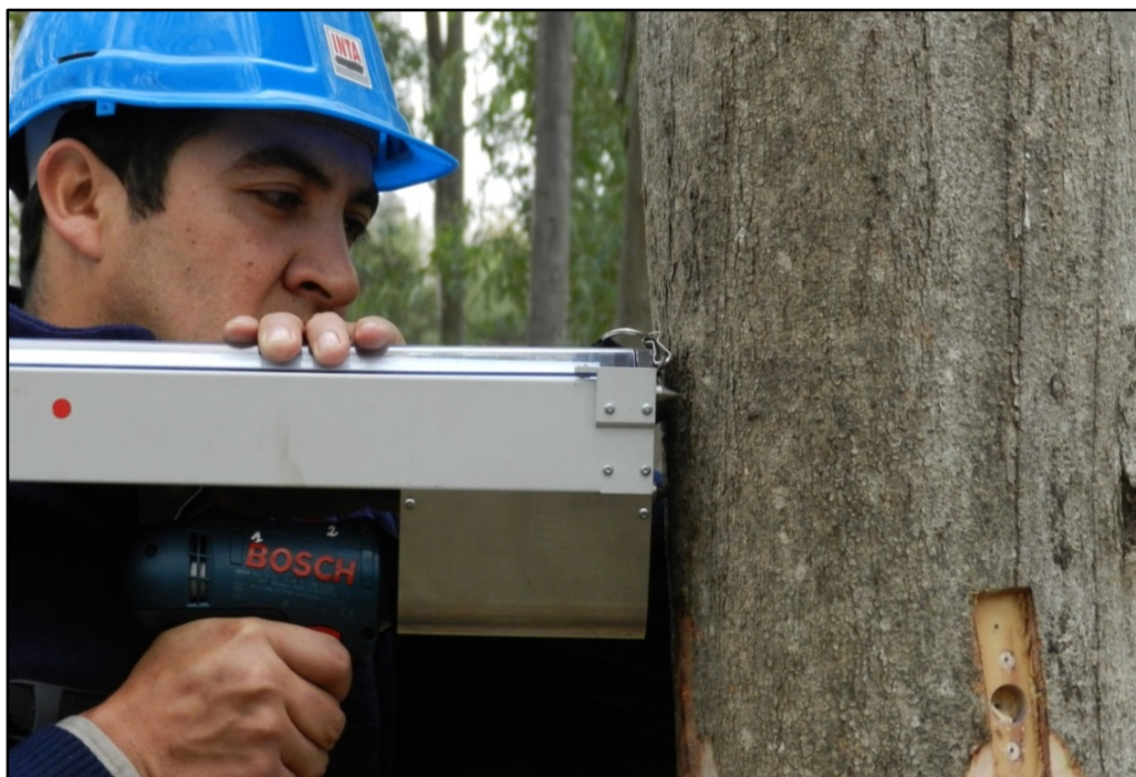
Figura 5. Medición de la Amplitud radial con el Resistógrafo: a y b) Detalle de las diferentes formas de registrar la amplitud del equipo; c) Perforación radial del fuste.
