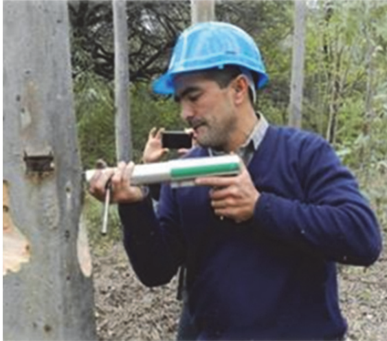
Figura 9. Determinación indirecta de densidad con Pilodyn
