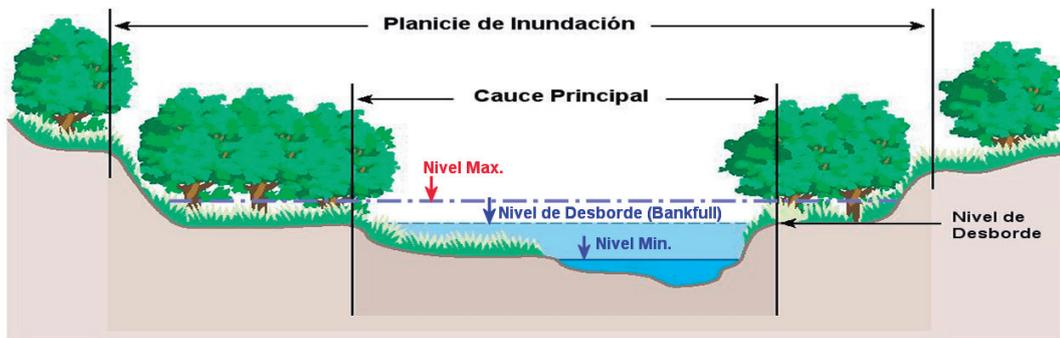
**Figura 4.** Esquema de la sección transversal de un río de llanura con los niveles característicos.
