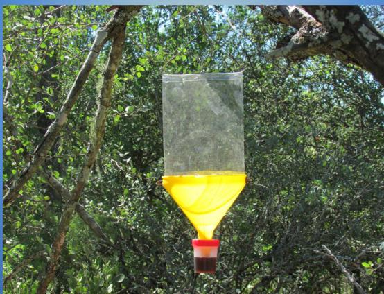
Figura 2: Trampa utilizada para la captura de insectos polinizadores (abejas). Esta trampa combina diferentes métodos de captura de insectos: intercepción del vuelo, atracción por color y química.
